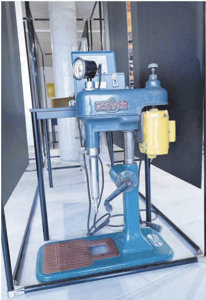
Màquina que separa el clorur potàssic del clorur sòdic i altres sals
