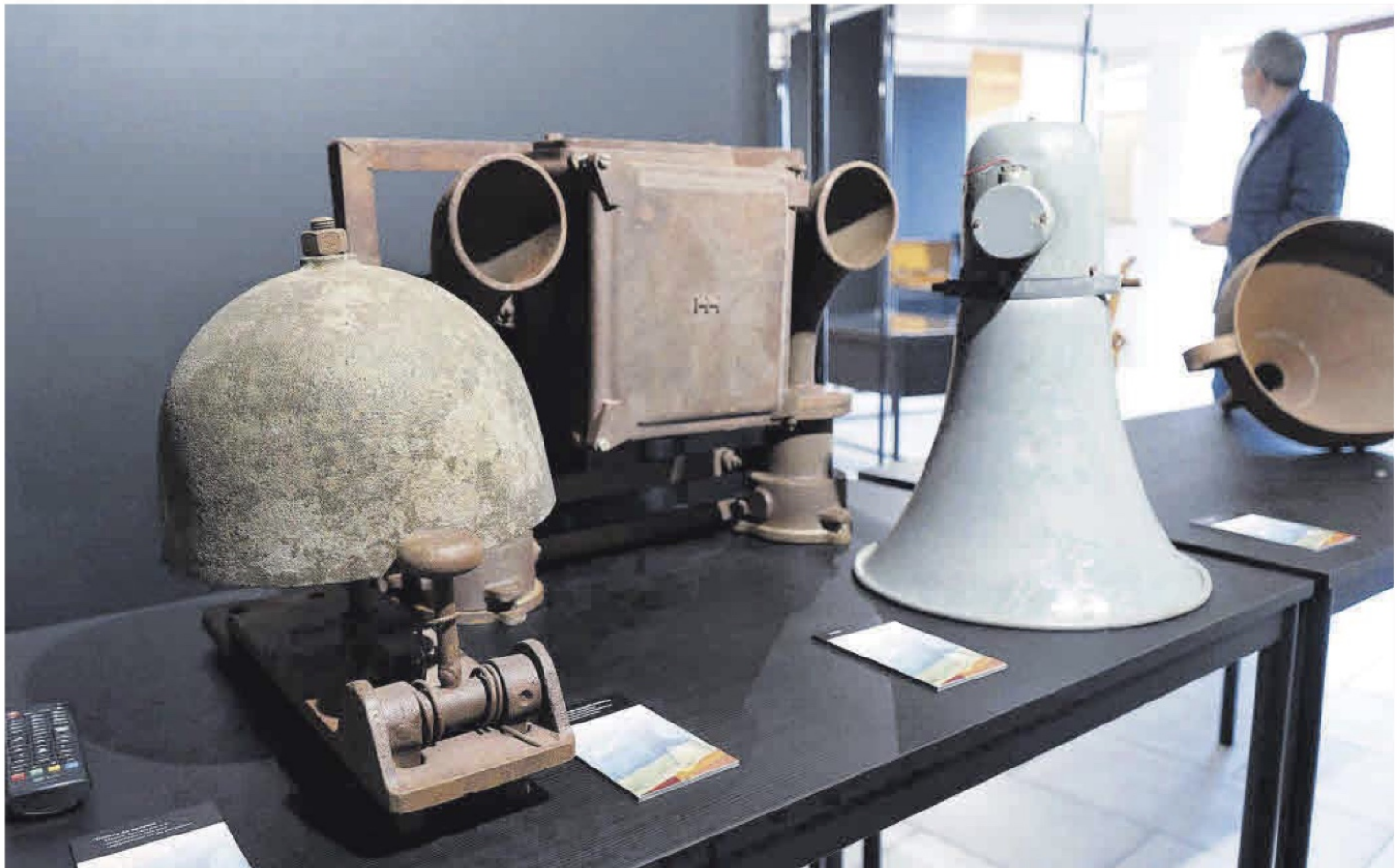
Conjunt d'estrís que servien per emetre senyals acústics i avisar els miners que treballaven a les instal·lacions de Súria
